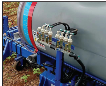
Sem componentes mecânicos ou elétricos, um monitor simples e confiável permite fácil supervisão do fluxo, acusando instantaneamente alguma ponta obstruída.
