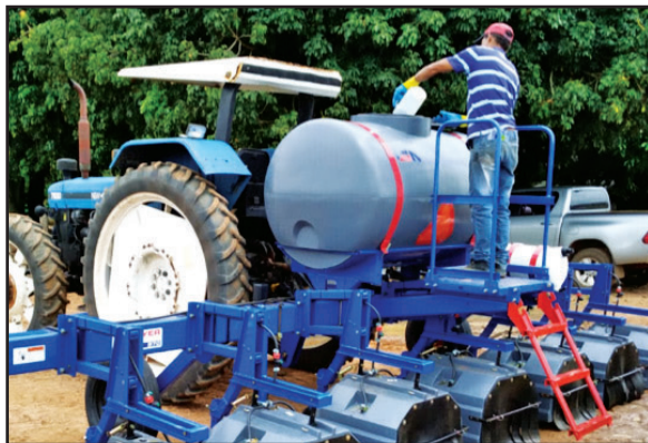
Plataforma com escada que facilita o abastecimento dos tanques. Projetada conforme NR12, anexo II, MTE.
