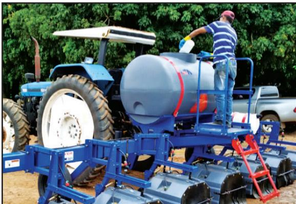
Plataforma com escada que facilita o abastecimento dos tanques. Projetada conforme NR12, anexo II, MTE.
