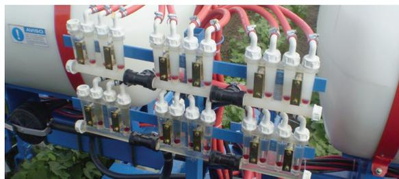
Sem componentes mecânicos ou elétricos, um monitor simples e confiável permite fácil supervisão do fluxo, acusando instantaneamente alguma ponta obstruída.
