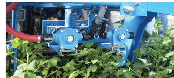
Bombas de deslocamento positivo, com roletes, combinam simplicidade e eficiência com elevada resistência à ação corrosiva dos herbicidas. Sem a necessidade de ajustes ou lubrificação, podem ser facilmente removidas para limpeza ou manutenção.
